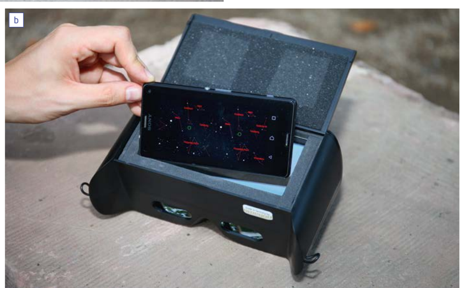
Abb. 2: Die Brille des Universe2go besteht aus einem Gehäuse, in dem sich ein Spiegel befindet. Wird das Smartphone an der dafür vorgesehene Position eingelegt, wird dessen Anzeige in das Blickfeld eingespiegelt. Stefan Fiebig
